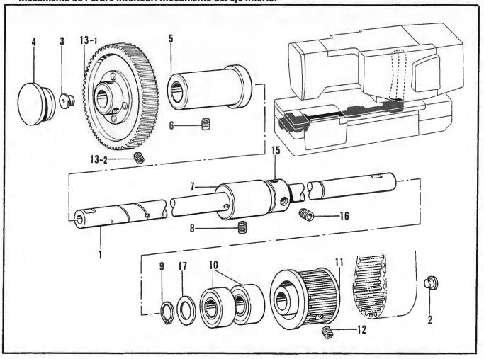
Q. O P頭部組付関係/Single pedal mechanism installed in the head/Maschineoberteil Mit Einem Pedal/ Mécanisme de l'ensemble de la tête pour une machine avec une seule pédale/ Mecanismo del conjunto de cabeza (de máquina) con pedal sencillo
