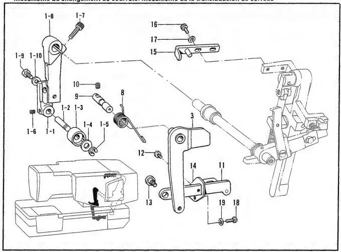
G. テンションプーリ関係 /Tension pulley mechanism/Spannrolle/ Mécanisme de la poulie de tension/Mecanismo de la polea de tensión
