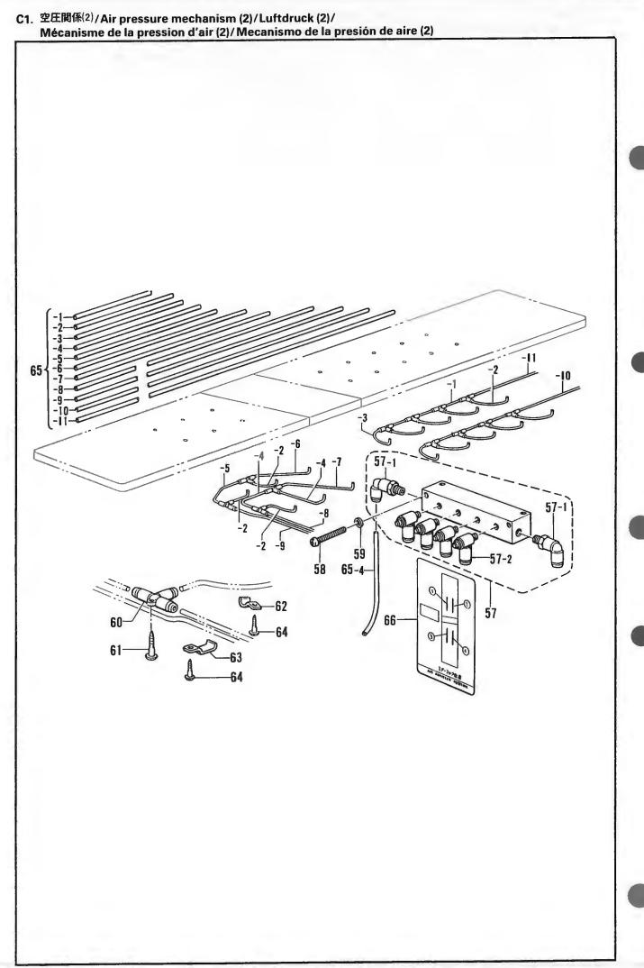
C1. 空圧関係(2)/Air pressure mechanism (2)/Luftdruck (2)/ Mécanisme de la pression d'air (2)/Mecanismo de la presión de aire (2)
