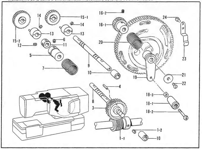
L. 糸切レ感知関係 /Thread breakage detector mechanism/Fadenbruchfühler/ Mécanisme du détecteur de cassure du fil/Mecanismo del sensor de cortes de hilo
