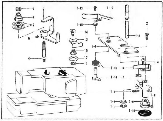
U. 減速関係 / Power transmitter mechanism / Kraftübertragungsvorrichtung / Mécanisme du transmetteur / Mecanismo del transmisor de potencia
